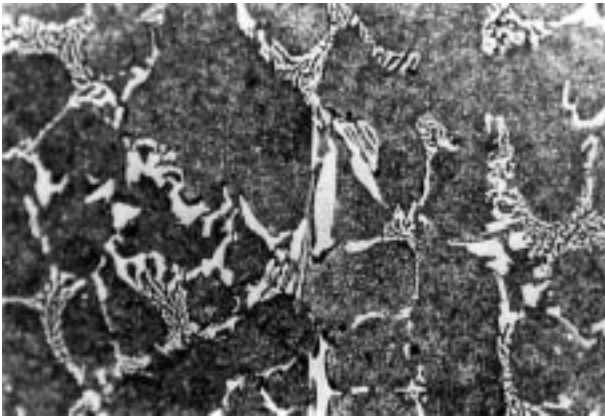
Şekil 5. Şekil 4'deki dökme demire su verildiğinde elde edilen içyapısı Ana Kütle : Martenzit + İkincil karbürler (artık ostenit) Ötektik : Birincil karbür + Martenzit.
