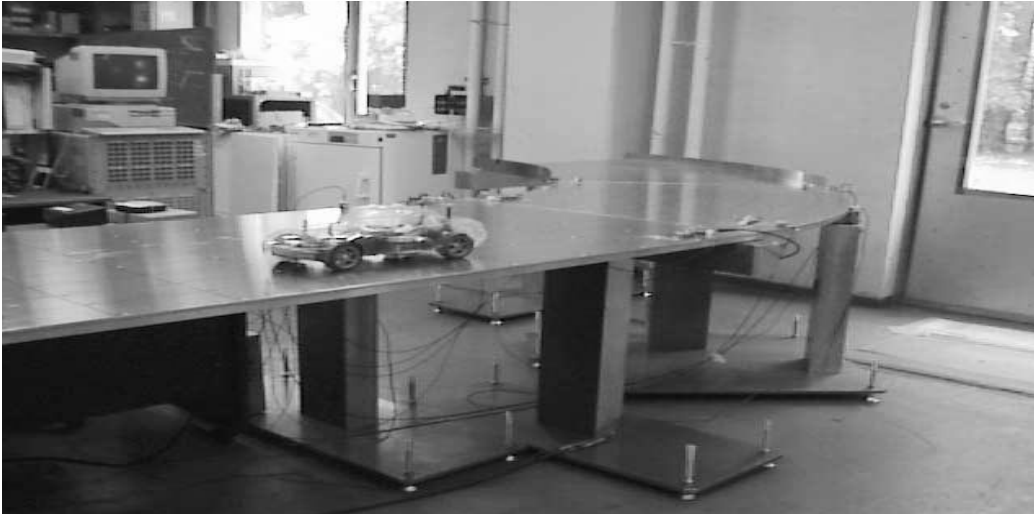
Şekil 3. Viyadük yol modeline ait deney düzeneği
